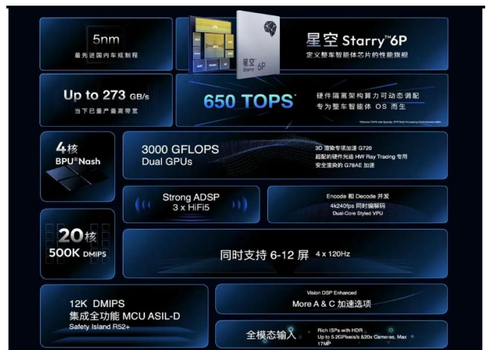
图表 7: 星空 6P 芯片核心性能
